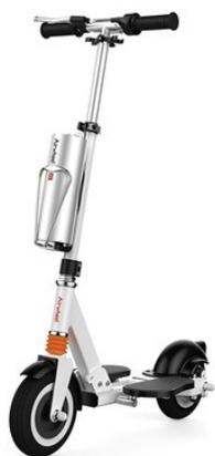
AirWheel Z3. Distance par chargement de la batterie (max): 22 km, Temps de charge: 2 h. Poids: 11 kg
